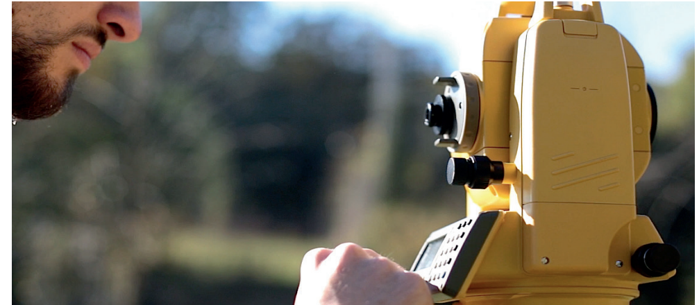
Stazione totale per rilievi topografici
